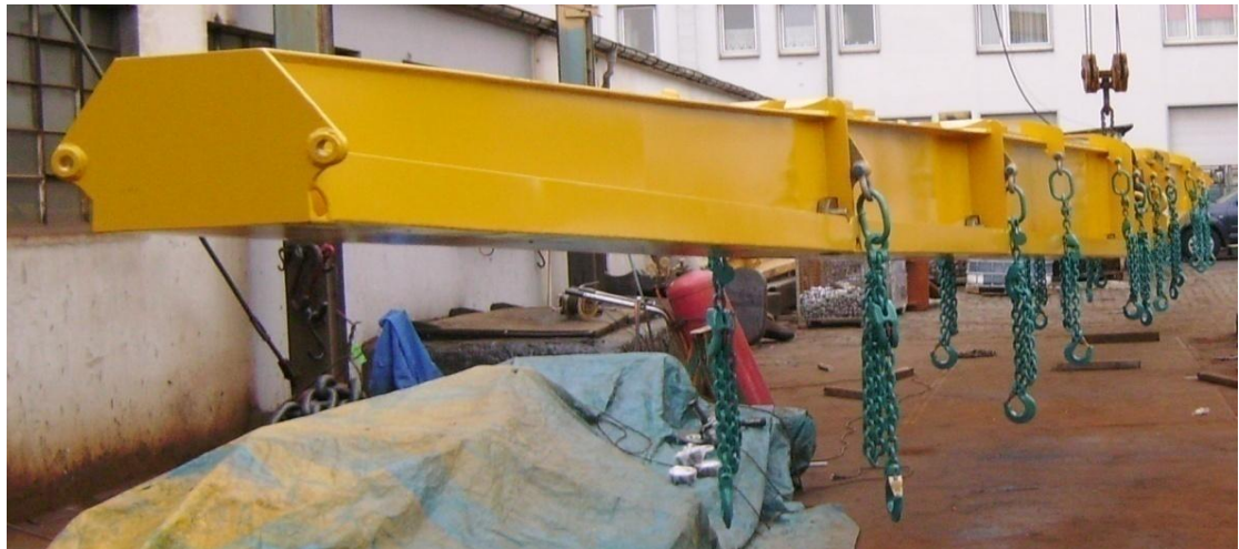
Traverse 40 / 80 t Tragfähigkeit, 30 Meter Nutzlänge
